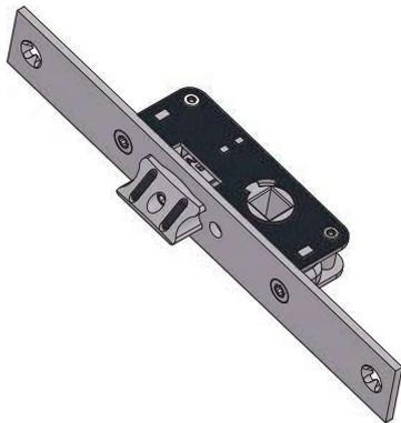
CARATTERISTICHE COSTRUTTIVE: Scatola e coperchio in acciaio zincato e plastificato - Frontale in acciaio inox - Scrocco anti-rumore in lega speciale nichelata - Ingegno maniglia in lega speciale zincata foro  $\varnothing$  8 mm.
